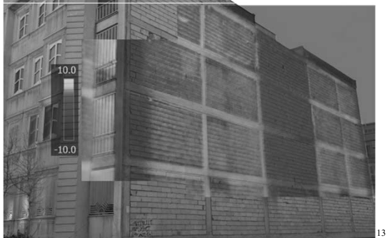
پلهای حرارتی در ساختمان - بهروز کاری
