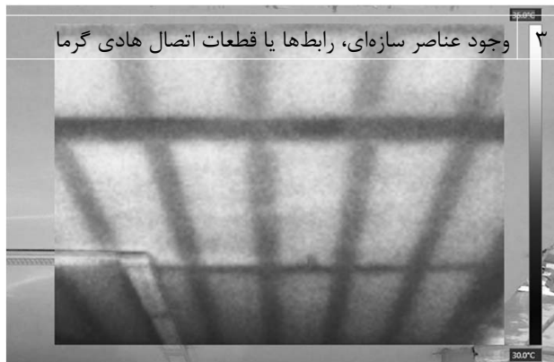
پلهای حرارتی در ساختمان - بهروز کاری
