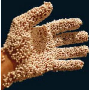
Il est impossible de réaliser un château de sable avec du sable sec : ce dernier ne présente quasiment aucune cohésion. Dès que l'on réalise une pente trop forte, une avalanche se déclenche et ramène la pente à la valeur de l'angle de repos déterminée par le coefficient de frottement du sable. Pour faire un pâté de sable, il faut ajouter de l'eau. L'eau confère son énergie de cohésion au sable et permet, à partir d'un ensemble divisé, d'obtenir un matériau cohésif.
